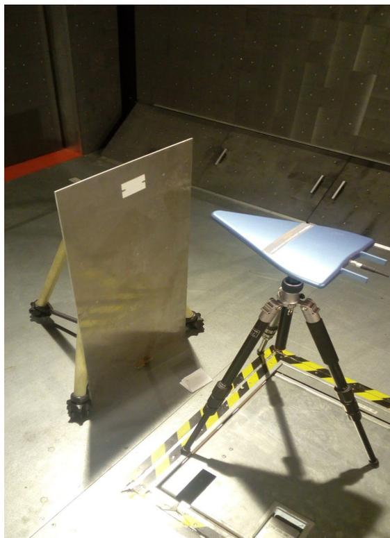
Рис.6. Измерение параметров функционирования RFID метки Target Tag при изменении положения в пространстве на металлической плите
