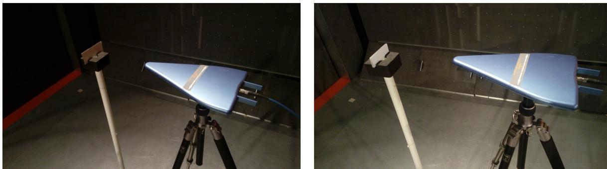
Рис.12. Измерение параметров функционирования RFID метки Confidex Silverline и Omni-ID Max Label при изменении положения в пространстве
