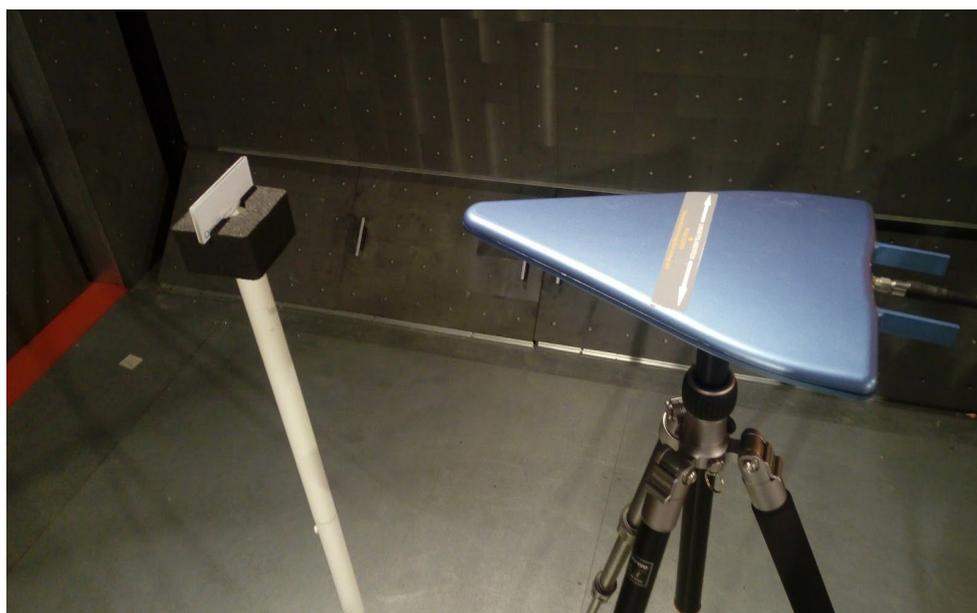
Рис. 4. Измерение параметров функционирования RFID-метки Target Tag при изменении положения в пространстве
