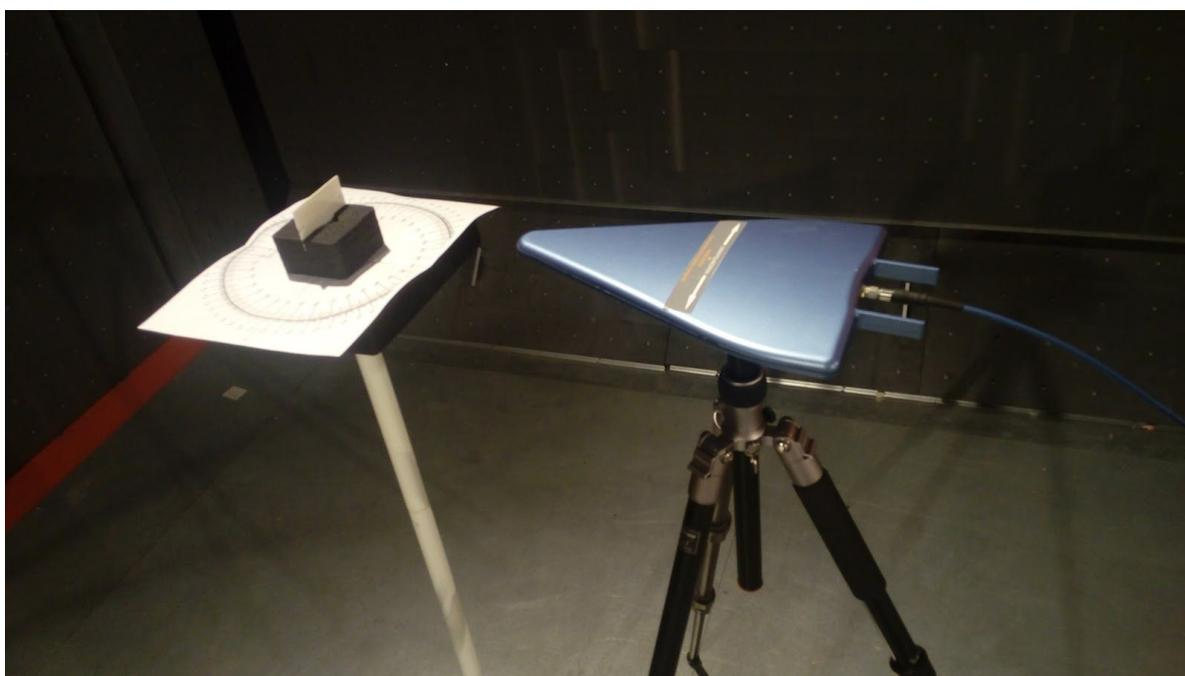
Рис.8. Измерение параметров функционирования RFID метки Target Tag при изменении положения в пространстве
